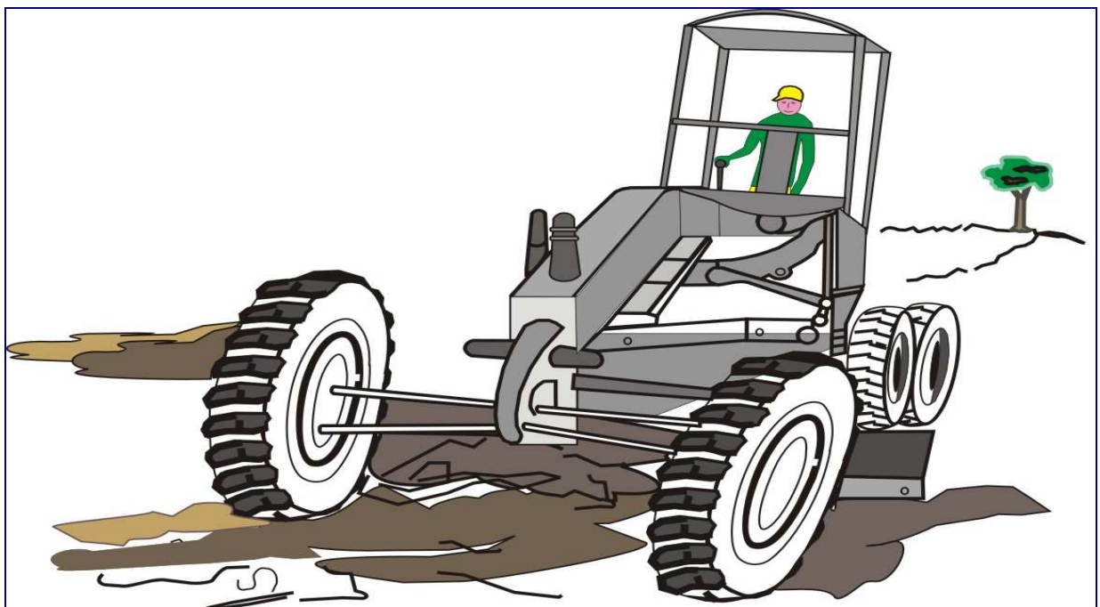
Figura IV.1.12 – Espalhamento do material.
