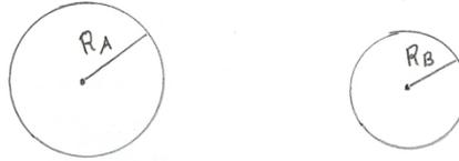
Quando as esferas forem ligadas, só haverá passagem de carga de uma para a outra se existir uma diferença de potencial entre elas.
