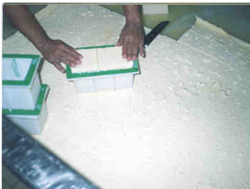
Figura 25 – Foto da moldagem e enformagem em formas de 3 Kg.
