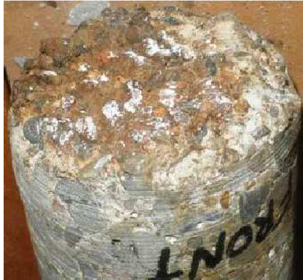
Seção polida de concreto com ataque por sulfato. Concreto de auto-estrada no Reino Unido. Formação de taumasita ao redor de agregado gráúdo do tipo litológico calcário acompanhado de fissuras.
