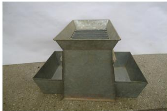
Fig. 1 – Processo de redução de amostra pelo separador mecânico – Método A
