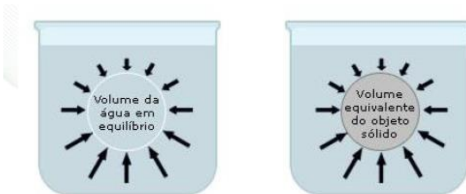
Fig. 6 - O empuxo é a força resultante da pressão exercida por um líquido sobre toda a superfície de um objeto mergulhado.
