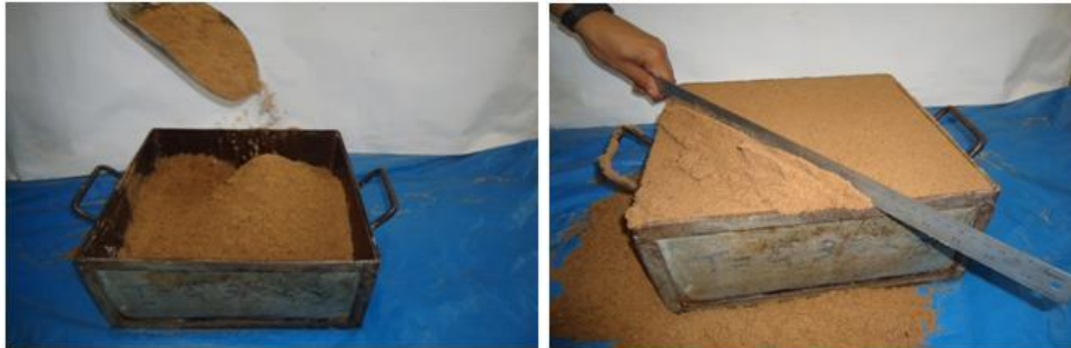
Fig. 4 – Determinação da massa unitária de agregados no estado solto.
