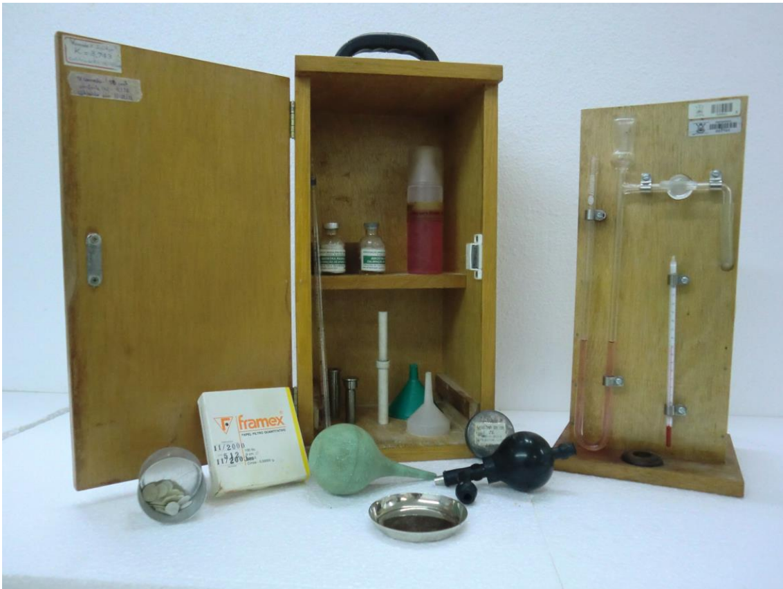
Fig. 3 – Aparelho Blaine de permeabilidade ao Ar
