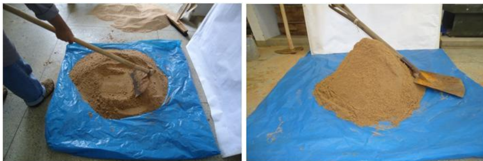
Fig. 3 – Processo de redução de amostra por tomadas aleatórias – Método C
