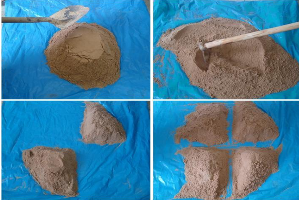
Fig. 2 – Processo de redução de amostra por quarteamento – Método B
