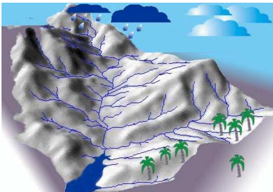
Figura 2 – Bacia hidrográfica e seu sistema de drenagem (Fonte: Agência Nacional de Água – ANA)
